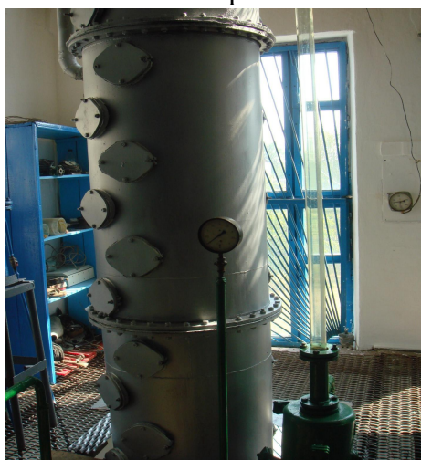
Instalație pentru concentrarea și deshidratarea deșeurilor etanolicе.
