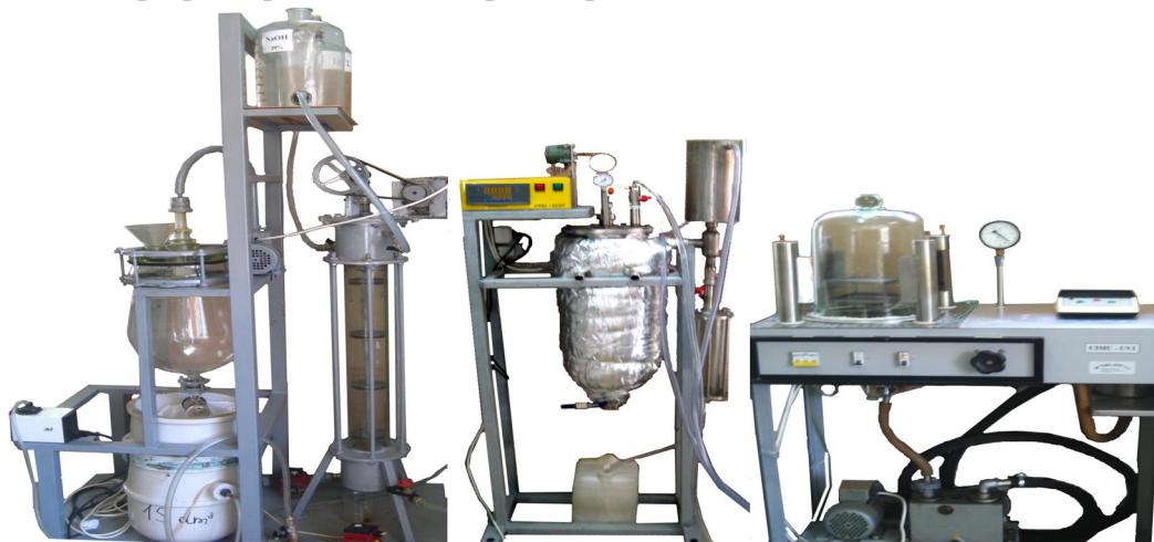
Instalație pilot de obținere a acidului tartric
